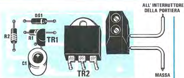
Fig. 3 Schema pratico di montaggio delle luci di cortesia per auto.
